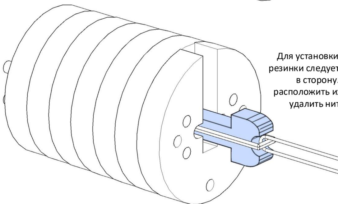
Для установки толкателя, резинки следует отвести чуть в сторону. Затем расположить их в вырезе и удалить нить/шнур.
