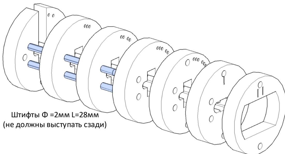
Штифты  $\Phi = 2\text{мм}$   $L=28\text{мм}$
