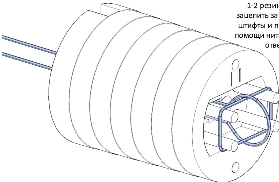
1-2 резинки следует зацепить за выступающие штифты и проташить при помощи нити/шнура через отверстие
