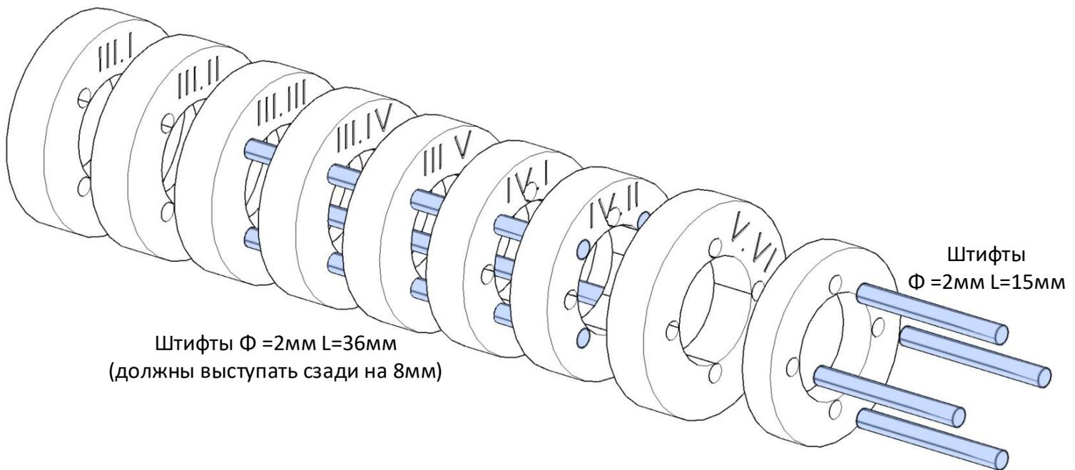
Штифты  $\Phi = 2\text{мм}$   $L=36\text{мм}$
